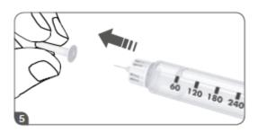
Retirar a proteção interior da agulha da caneta e descartá-la.
